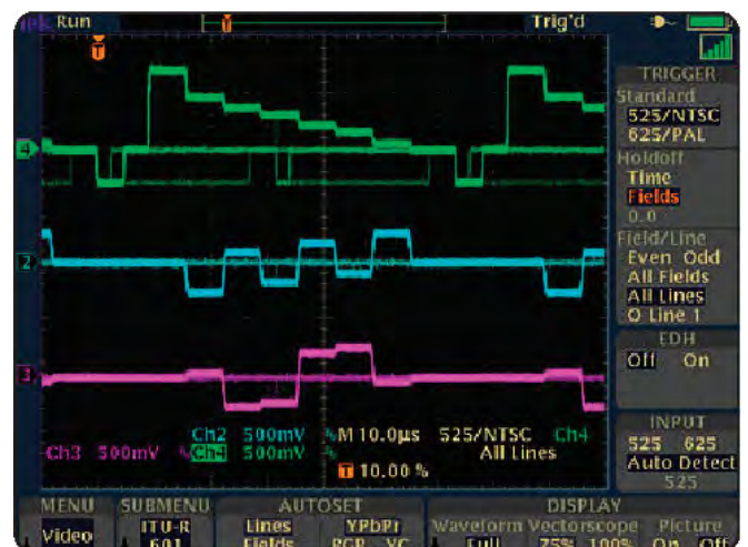
► 使用 TDS3SDI 601 串列數位視訊模組追蹤與辨識 ITU-R BT.601 視訊訊號。
