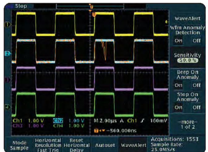
► WaveAlert 波形異常偵測功能，可以提醒您注意離「正常」輸入的異常波形，如通道 2 的突波所示。
